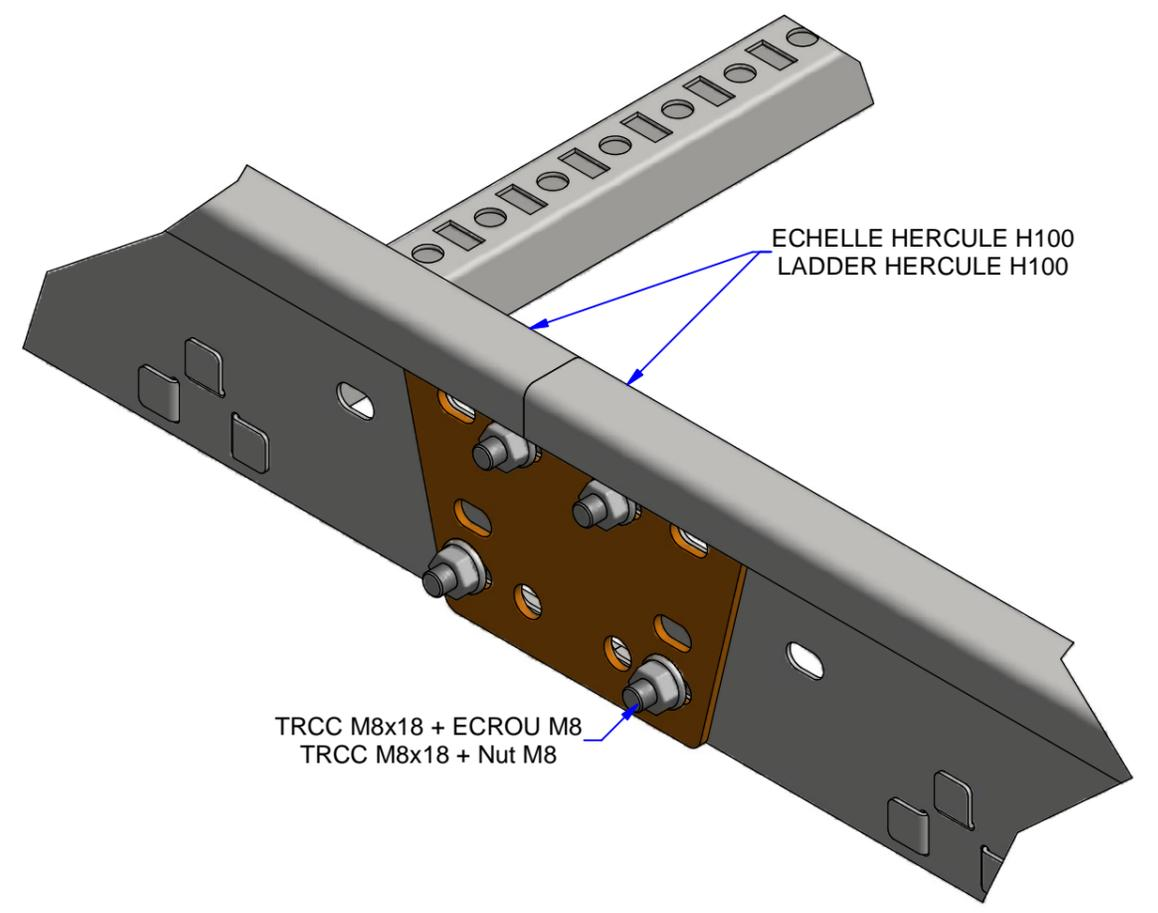
**SZ** : Tôle d'acier galvanisé avant fabrication suivant NF EN 10346 (S220 GD / Z).
